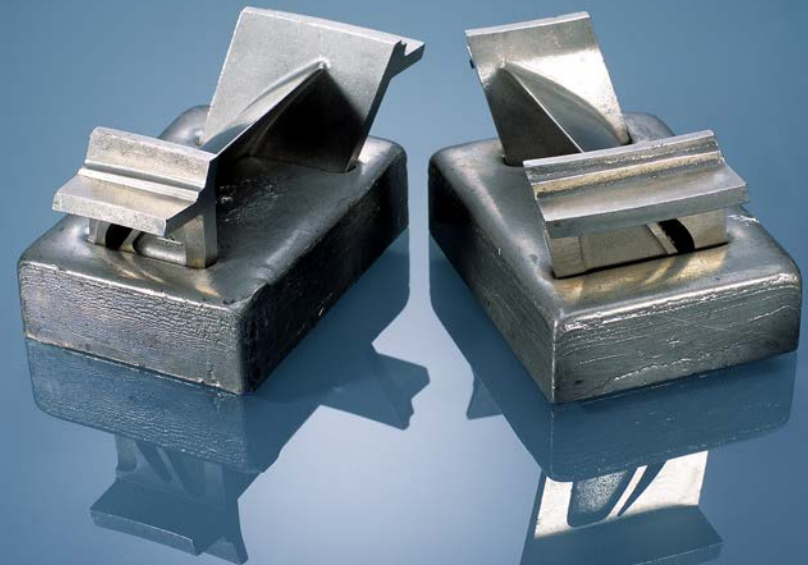
Spannen von Flugzeugturbinenschaufeln und Leitschaufeln mit MCP 137
