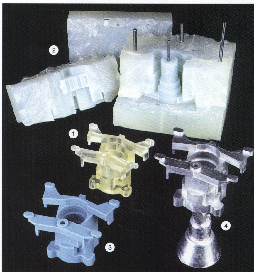
Bild 1. Werdegang eines Bauteils: SLA-Urmodell zur Herstellung der Siliconform (1), Siliconform (2), Wachsmodell (3) und Aluminium-Gußteil (4) (HEK GmbH)
