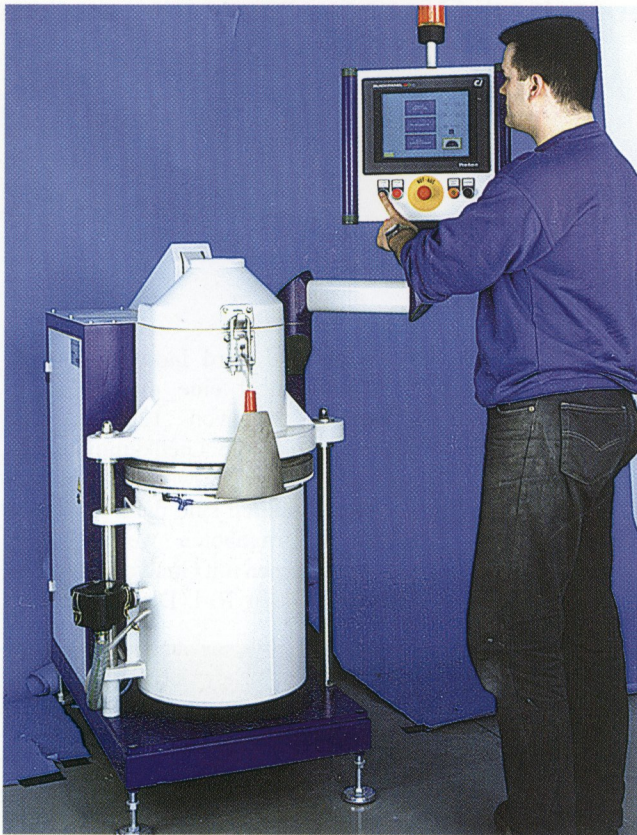
Bild 2. Die Vakuumgießanlage MCP 300 besteht aus einer Vakuumkammer und einer Steuerungseinheit. Sie erlaubt das Gießen unter Vakuum, Druck und Schwerkraft
