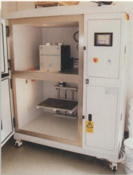
*Brut-Stätte: Die Gießkomponenten werden oben in einem speziellen Prozessmodul aufbereitet und dosiert, gegossen wird in der unteren Kammer.*
