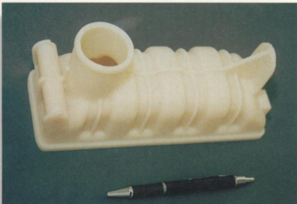
*Innerhalb von 14 Tagen können Serien von 30-50 Stück erzeugt werden; Beispiel: Gegossener Polyamid-Deckel (Bilder: Klaus Vollrath)*
