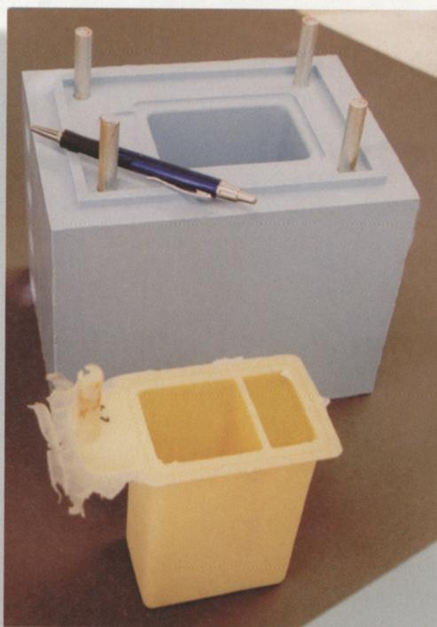
Die Form besteht aus Silikon, das um ein Prototypbauteil herumgegossen wurde. Nach dem Vernetzen wird der Silikonblock aufgeschnitten und das Bauteil entfernt.
