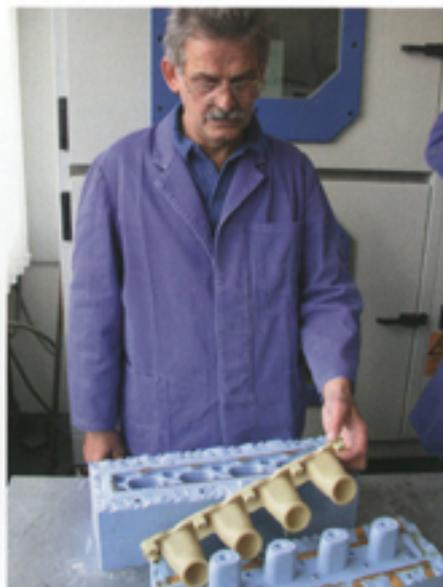
*Haupteigenschaften von vakuumgegossenen Prototypen und Vorserien sind Luft-, Wasser- und Gasdichtigkeit, Beständigkeit gegenüber Chemikalien und Massgenauigkeit. Durch die überzeugenden Materialeigenschaften eignet sich der Vakuumguss von Nylon selbst für anspruchsvolle Teile wie diesen Ansaugkrümmer. (Foto mit freundlicher Genehmigung von RPM Helmstedt, Germany)*
