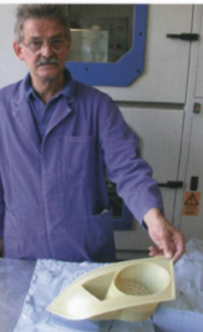
*Massgenauigkeit und eine 1A Oberfläche hatten bei diesem Lampengehäuse oberste Priorität. Der mit dem MCP Nylonvakuumgiessverfahren hergestellte Prototyp erfüllt die sehr hohen Anforderungen. (Foto mit freundlicher Genehmigung der Fa. Teufel)*
