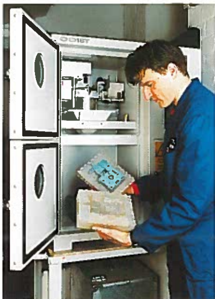
Die Abbildung zeigt die Vakuumgießmaschine (001 ST) in Laborausführung. In diesem Falle wird eine Vakuumgießform aus Silikonkautschuk und das daraus entstandene Wachsteil gezeigt. MCP-Vakuumgießmaschinen können zur Prototypenfertigung von Wachs und Kunststoffteilen eingesetzt werden.
