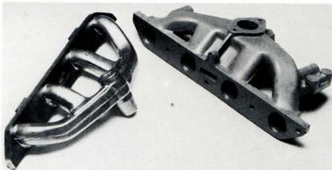
Ansaugkrümmer für Pkw-Motor aus GFK-Compound (rechts). Links: Schmelzkern aus niedrigschmelzender Legierung.
