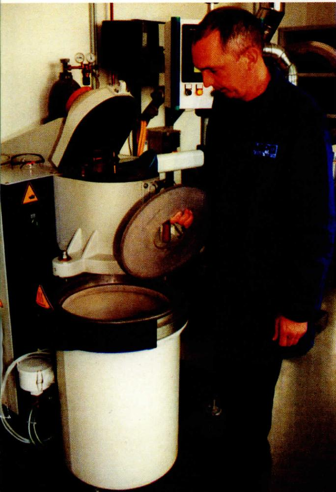
*In der Schmelzkammer (oben) wird das Metall auf Gießtemperatur gebracht, die Gießkammer (unten) wird zum Gießen eingeschwenkt und luftdicht angedockt*
