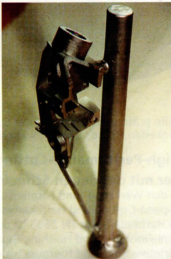
*Komplex und präzise: Aluminium-Gußteil für eine Kamera*
